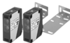
D – Vorrichtungen, die das Vorhandensein einer Person oder eines Hindernisses auf dem Boden auf einer Seite des Tores erkennen, wie z. B. Lichtschranken. Achtung! Wird die Kombination C + D verwendet, muss das Gerät D regelmäßig in Abständen von nicht mehr als 6 Monaten überprüft werden.
