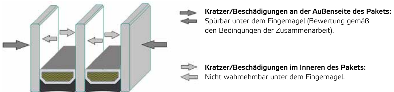
Abbildung: Dreischeiben-Paket mit zwei Kammern
