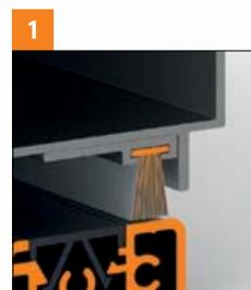
LE JOINT SUPPLÉMENTAIRE À BROSSURE ASSURE UNE ÉTANCHÉITÉ ENTRE LE VANTAIL ET LE SEUIL.
