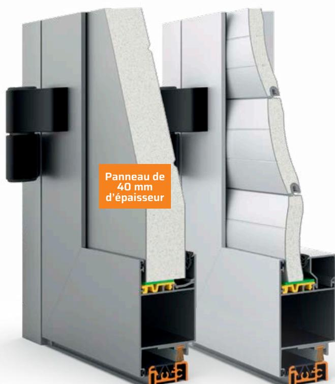
Système de portes latérales basant sur les profilés de 51 mm de profondeur. Les vantaux sont remplis de profilés de portes enroulables en aluminium ou de segments de 40 mm d'épaisseur. Afin d'obtenir une homogénéité du dormant et des vantaux ainsi qu'une cohérence parfaite avec le revêtement de la porte de garage, les profilés sont peints sur deux faces en couleur choisie parmi 200 couleurs disponibles du nuancier RAL.
