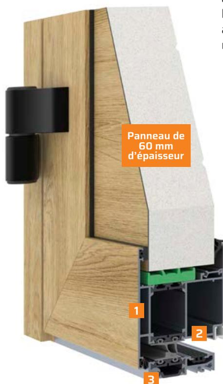
Le système de portes DB 75 est constitué de panneaux d'épaisseur augmentée à 60 mm. Grâce à l'utilisation des panneaux isolés thermiquement avec les profilés de profondeur de 75 mm ces portes sont une solution idéale pour les maisons à basse consommation d'énergie et pour les maisons passives. Elles sont disponibles en version sans nervures, plaquées ou peintes sur la face extérieure.
